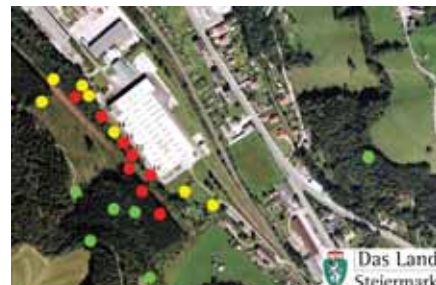
Abbildung 2: Lage der belasteten Punkte im Nahbereich eines Aluminiumrecyclingunternehmens (grün ≤ 0,8 mg%F; gelb >0,8 bis ≤ 2 mg%F; rot > 2 mg%F im ersten Nadeljahrgang)
