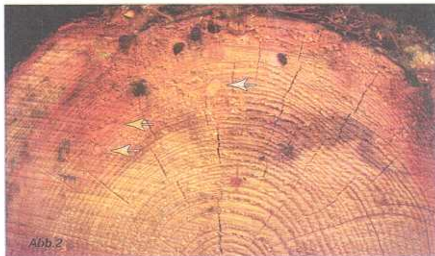
Abb. 2: Fäuleausbreitung im Querschnitt
