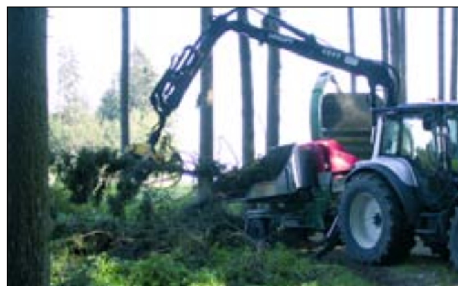
Abbildung 4: Hackschnitzelerzeugung durch mobilen Häcksler im Wald - auch eine Forst- schutzmaßnahme
