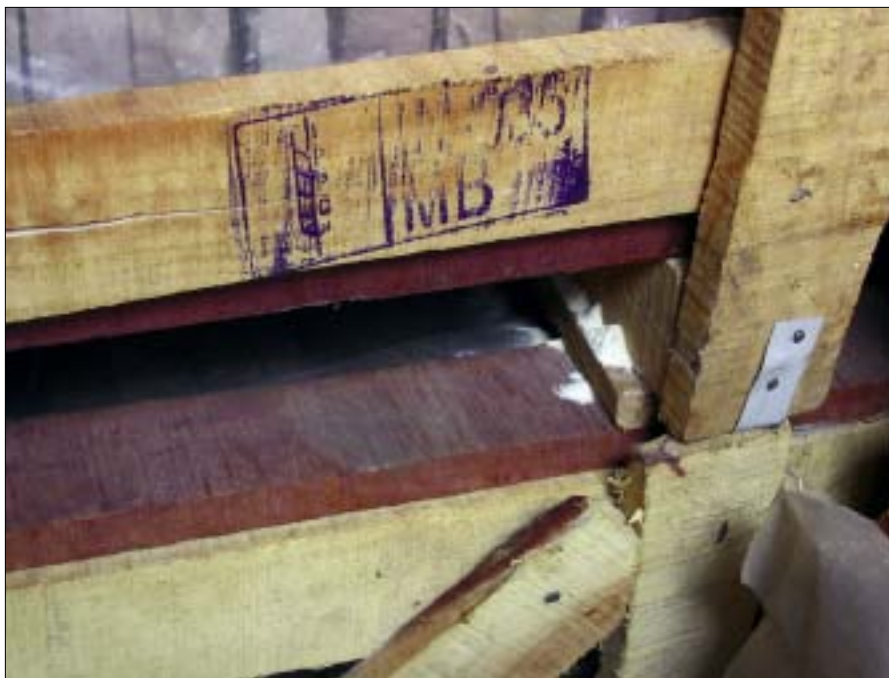
Abbildung 1: „Behandeltes“ Verpackungsholz mit IPPC-Markierung und Bohrmehl von lebenden Insekten
