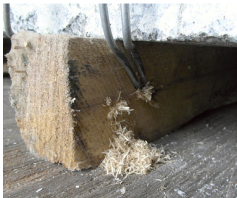
Abbildung 4: Fraßspäne durch eine Bockkäferlarve an einem Balken einer chinesischen Palette (Foto: Manuel Völkl, BFW).
