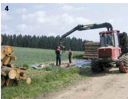
Aufbau des Folienlagers: 1 Mäuseschutzgitter, 2+3 Ausbringen der Bodenfolie, 4 Richten der Unterleghölzer, 5 Errichtung der Polter, 6 Feinarbeit am Polter
