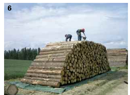
Aufbau des Folienlagers: 1 Mäuseschutzgitter, 2+3 Ausbringen der Bodenfolie, 4 Richten der Unterleghölzer, 5 Errichtung der Polter, 6 Feinarbeit am Polter
